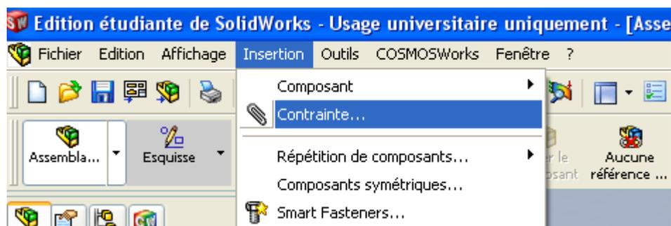
La fenêtre de contrainte s'ouvre alors. Sélectionner l'alésage de la pièce « Alésage »
