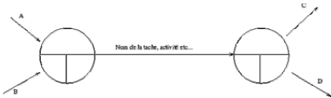
Figure 7.1: Structure d'un réseau PERT
