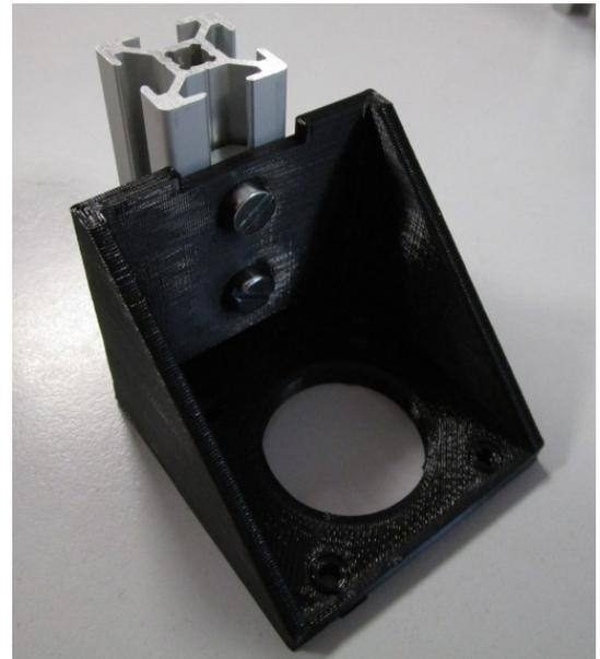
Fixer le moteur à l'aide de 2 vis M3x10mm au niveau des 2 trous juste au dessus du profilé, en n'omettant pas de mettre une rondelle M3 sous la tête de vis et en orientant les fils vers le l'encoche du support moteur :
