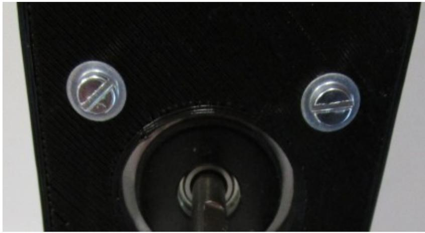
Fixer les 2 autres trous à l'aide de 2 vis M3x16 traversant les supports d'extrémités, ce qui aligne l'axe du moteur, l'écrou et le support de roulement 608ZZ (passer les vis en entier en premier) :
