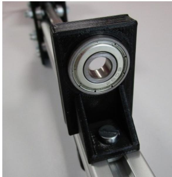
Enfiler la tige filetée au travers du roulement à billes, et sans l'engager dans l'écrou du chariot, visser un écrou sur la tige filetée. Cet écrou servira de serrage pour le roulement à billes 608ZZ :
