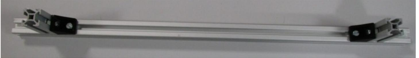
Mettre à plat l'ensemble obtenu et fixer à nouveau 2 petites équerres à 20mm de chacune des extrémités :
