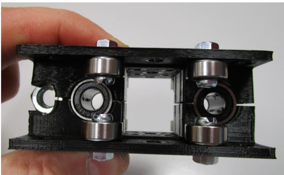
Une fois fait, mettre en place une première vis de M3x40 en mettant une **petite rondelle à la tête et avant l'écrou Nylstop** (pour ne pas oublier de le faire pendant le vissage, engager dès maintenant une rondelle sur chaque vis M3x40). **Ne pas serrer à fond** : il est normal d'avoir un petit jour de l'ordre de 1
