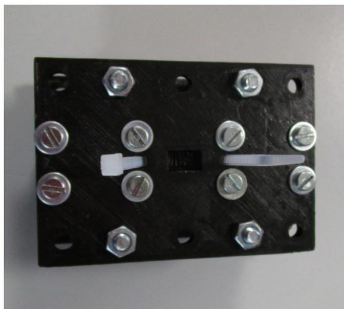
Chauffer ensuite avec un briquet l'écrou en le tenant avec une pince puis venir le placer dans son empreinte, en veillant à ce que le plat soit au fond de l'empreinte. L'axe de l'écrou doit rester un petit
