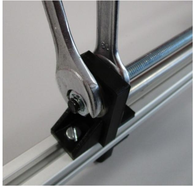
Voilà, c'est terminé : le bloc de translation est monté. On doit pouvoir tourner manuellement le coupleur d'axe sans difficulté pour entraîner le chariot :
