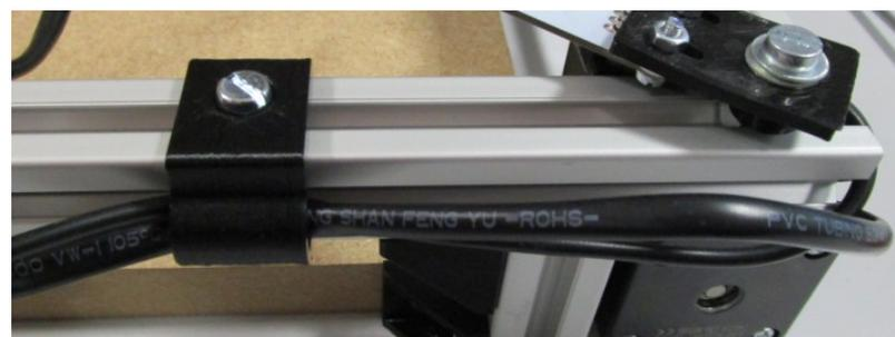
On pourra solidariser les câbles de endstop et de moteur du X ensemble en veillant à bien les laisser mobiles :
