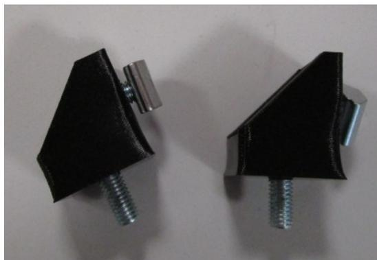
Les engager sur le profilé de 15cm latéralement en les prépositionnant au tiers inférieur et fixer ces 2 équerres dans les trous supérieurs de la face arrière du chariot des X à l'aide d'un écrou M5 :
