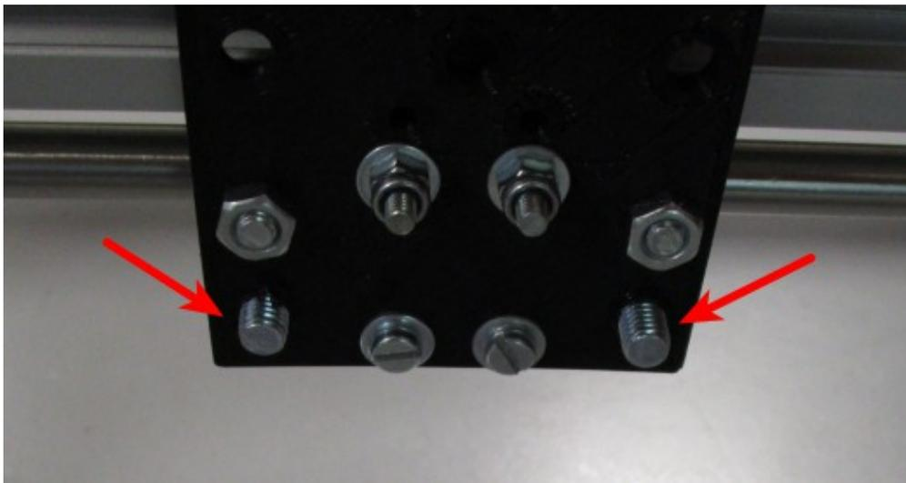
A ce moment là, positionner le bloc de Z en regard de la face avant du chariot de l'axe X, de façon à ce que les trous du support de roulement à billes soient en vis-à-vis des vis :
