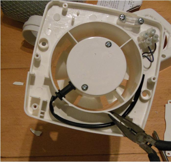
Pour monter l'adaptateur de diamètre de ce côté, nous allons avoir besoin d'un passage pour enfiler celui-ci. J'enlève donc les petits montants en plastique pour obtenir un cylindre. Vous pouvez utiliser une pince. Si vous êtes plus civilisés, un cutter et une dremel feront encore mieux le travail.
