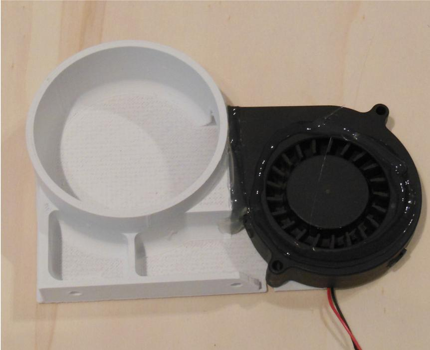
Nous continuons donc notre collage en réalisant cette fois le raccord entre «AirInlet» et le ventilateur radial. Déposez un filet en suivant le pourtour du ventilateur tout en laissant une marge de sécurité, puis apposez AirInlet de sorte qu'il soit bien centré. Attention, aucun excès de colle ne doit venir perturber la rotation du ventilateur.
