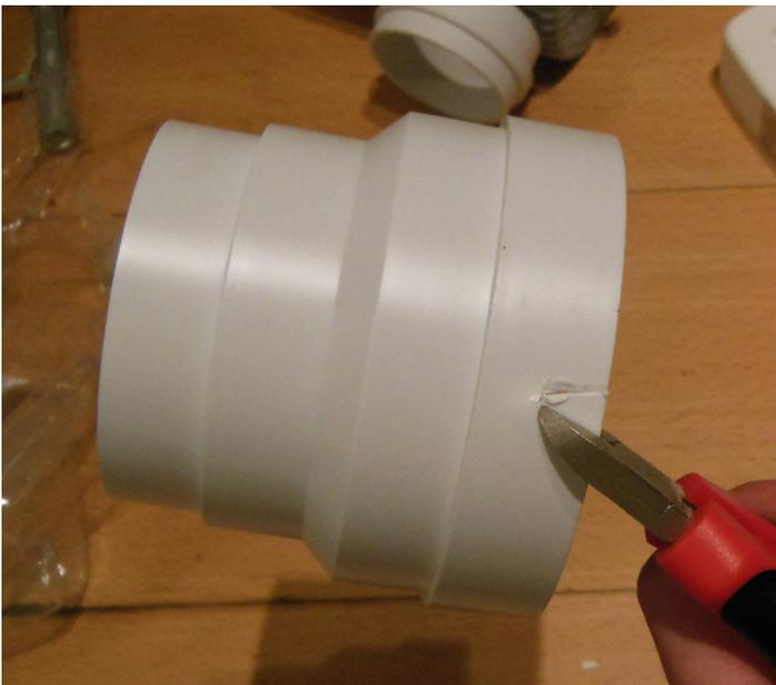
Toujours armé de ma pince, je fais un petit passage dans l'adaptateur de diamètre afin de pouvoir enfiler celui-ci malgré la présence du câble d'alimentation.
