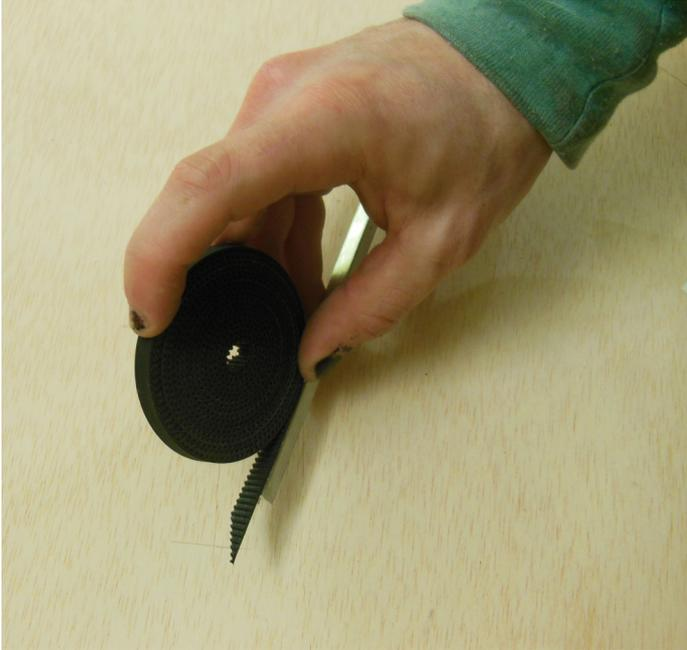
Après avoir retiré la partie supérieure du schotch double-face, il ne reste plus qu'à dérouler la courroie, en faisant attention à l'alignement parfait de celle-ci sur le profilé. Une astuce consiste à utiliser une poulie folle que l'on fait rouler en emportant la courroie.
