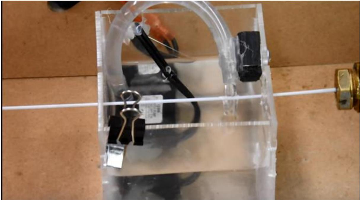
Le diamètre du fil étant minime, une pompe à eau d'aquarium aura un débit suffisant pour refroidir ce dernier et atteindre la température de 50°C.
