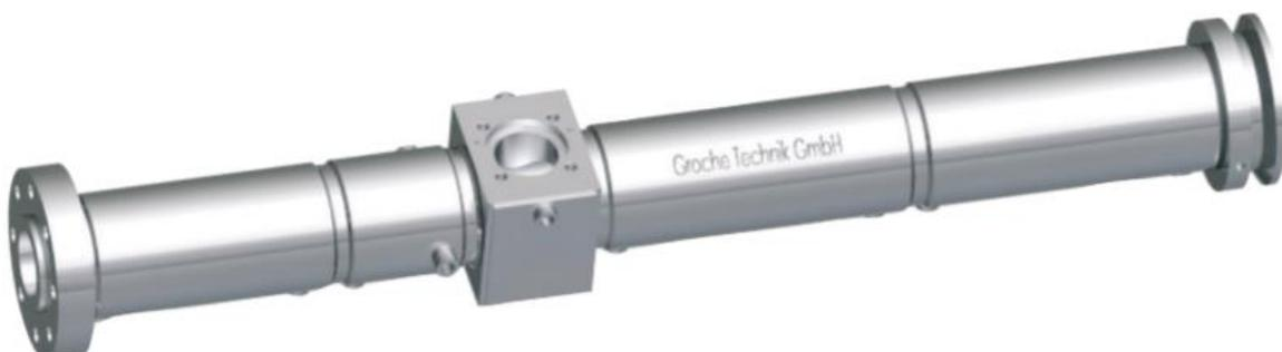
Le fourreau remplit plusieurs fonctions, il assure le guidage de la vis, il supporte l'embout du fourreau, la buse, les éléments chauffants ainsi que la trémie d'alimentation. Couplé à la vis il assure également la pression d'injection.
