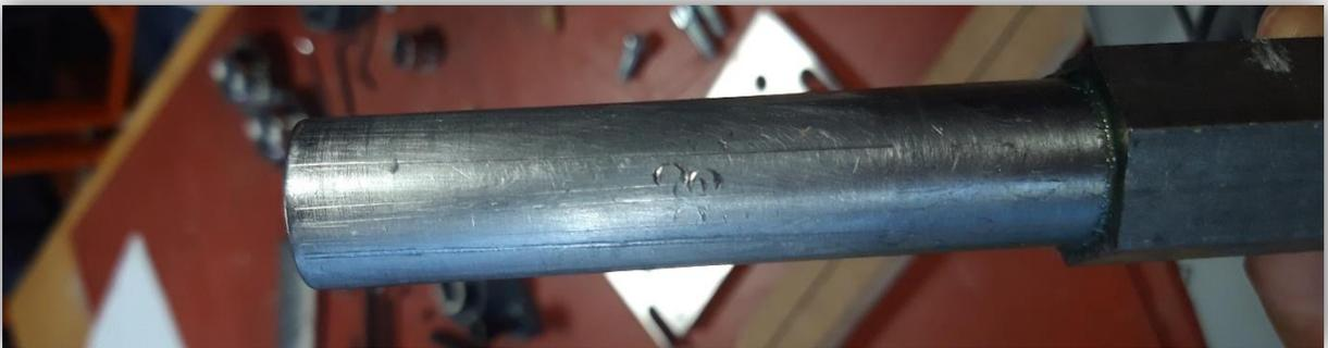
Ensuite, comme dit dans la partie 1, nous avons eu des problèmes avec le moteur, et notamment lors de l'assemblage. En effet, le moteur de récupération que nous avons à notre disposition possédait un arbre de 2.5cm de diamètre, mais les arbres du broyeur, notamment le plus long (celui qui est connecté au moteur), avait un diamètre de 2cm.
